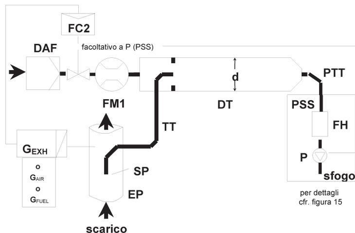
Il gas di scarico grezzo viene trasferito dal condotto di scarico EP al tunnel di diluizione DT attraverso la sonda di campionamento SP e il condotto di trasferimento TT. Il flusso totale attraverso il tunnel viene regolato con il controllore di flusso FC3 e la pompa di campionamento P del sistema di campionamento del particolato (figura 16).
