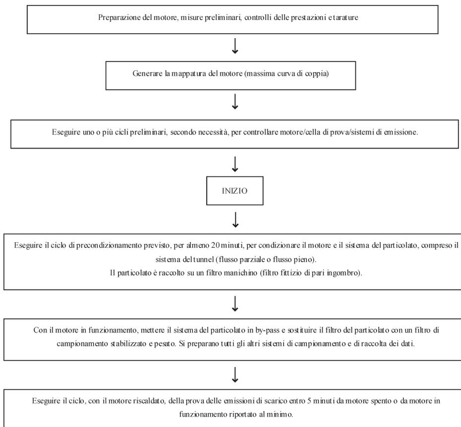
Si possono eseguire uno o più cicli preliminari secondo necessità, per controllare il motore, la cella di prova e i sistemi di emissione prima del ciclo di rilevamento.
