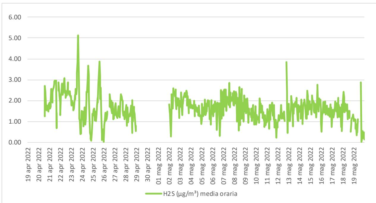
Figura 7.1 - Concentrazione ( $\mu\text{g}/\text{m}^3$ ) media oraria di H<sub>2</sub>S.
