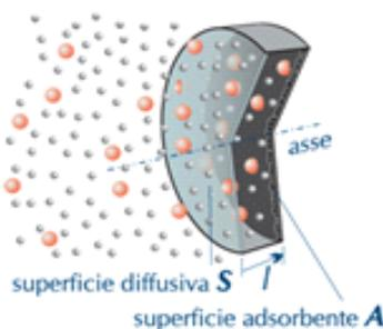
**Figura 3.2 - Sezione dell'adsorbitore**
