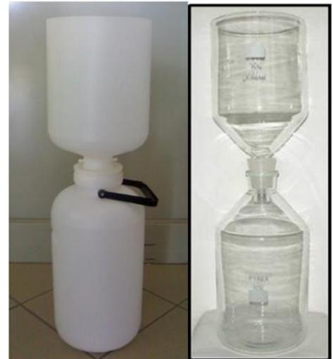
piombo e nichel, nonché altri metalli di interesse, di IPA (Idrocarburi Policiclici Aromatici) come richiesto dal D. Lgs 155/2010 e s.m.i., e di PCB (Policlorobifenili). Il materiale del "BULK" si differenzia a seconda del tipo di inquinante da indagare: per i microinquinanti organici si utilizza un depobulk in vetro pyrex silanizzabile, per i microinquinanti inorganici si utilizza il depobulk in polietilene HDPE.
