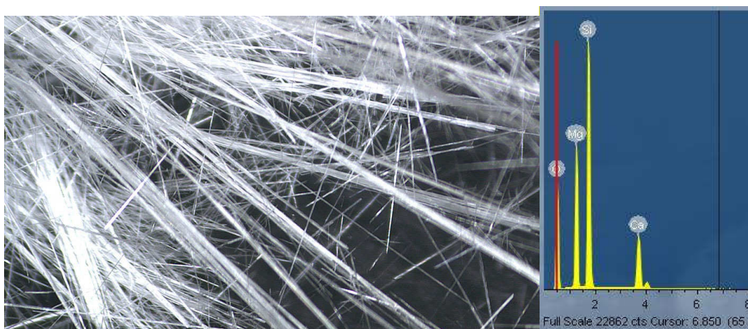
Fibre di tremolite osservate al microscopio elettronico e relativo spettro di microanalisi.
