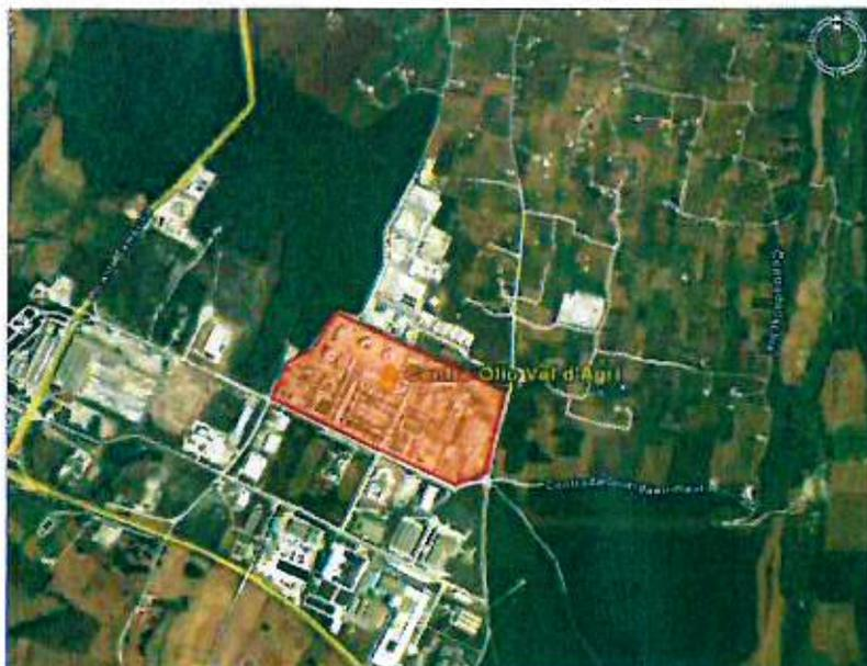
Esso è in esercizio dal 2001 ed occupa una superficie di circa 180.000 mq. Nell'opificio sono trattati gli idrocarburi (separazione dell'olio, del gas e delle acque di strato) provenienti dai giacimenti della zona. L'olio greggio stoccato in appositi serbatoi è
