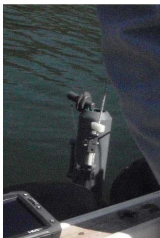
Foto 9: Stazione 1, bottiglia Niskin utilizzata per il prelievo alla quota profonda.
