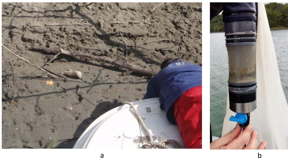
Foto 8 a, b: Matrici prelevate nella stazione 1: a) prelievo del sedimento; b) bicchiere per la raccolta di fito e zooplancton.
