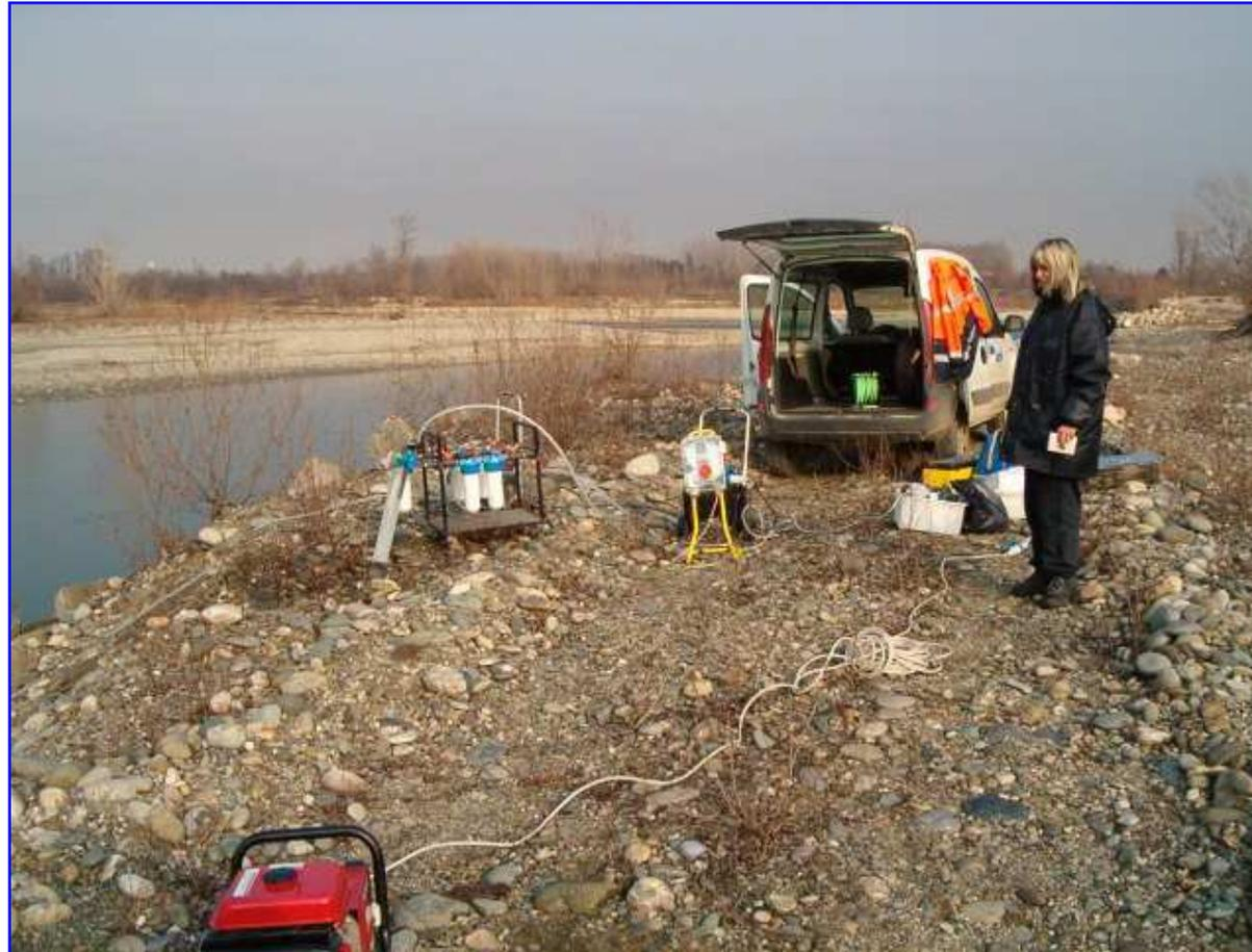
**Attività di controllo dell'acqua del fiume Dora Baltea In occasione di uno scarico di effluenti radioattivi liquidi**
