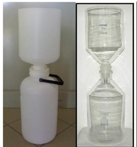
di interesse e di PCB (Policlorobifenili). Il materiale del "BULK" si differenzia a seconda del tipo di inquinante da indagare: per i microinquinanti organici si utilizza un depobulk in vetro pyrex silanizzabile, per i microinquinanti inorganici si utilizza il depobulk in polietilene HDPE.
