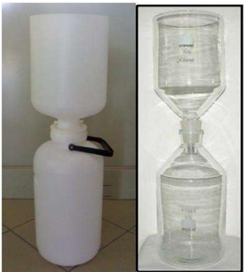
**Figura 4. Materiale di cui è costituito il depobulk**
