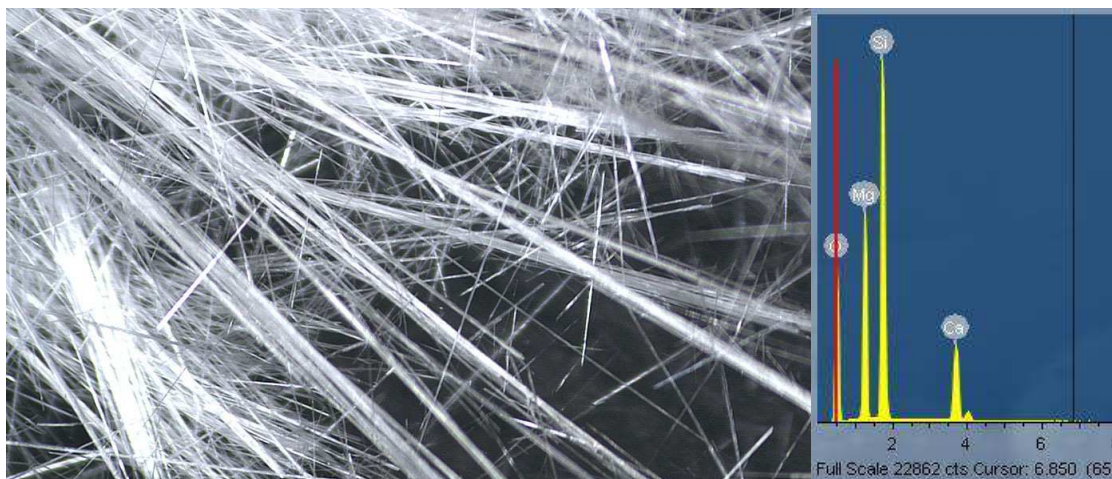
Fibre di tremolite osservate al microscopio elettronico e relativo spettro di microanalisi.
