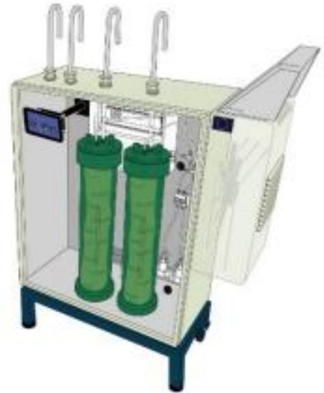
*Figura n. 2 Centralina di monitoraggio in continuo dell'odore*
