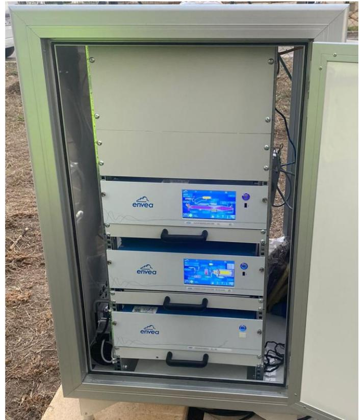
*Figura n. 5 Centralina di monitoraggio in continuo H<sub>2</sub>S*
