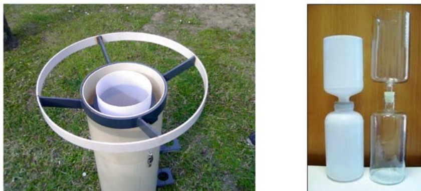
Figura 6.2 - Deposimetri in vetro e in HDPE.
