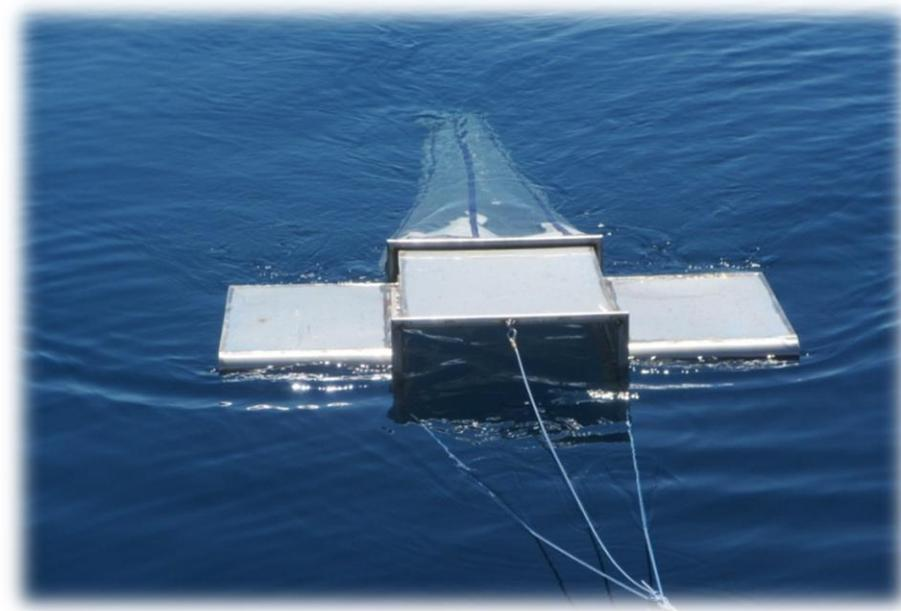
La rete utilizzata per la raccolta delle microplastiche previste dal Modulo 2 è la **manta**
