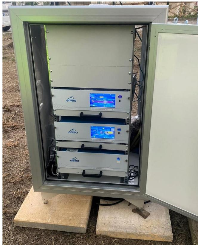
***Figura n. 5 Centralina di monitoraggio in continuo H<sub>2</sub>S***
