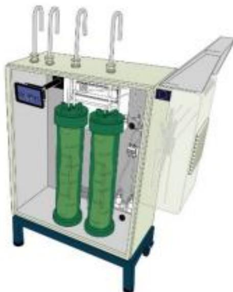
*Figura n. 2 Centralina di monitoraggio in continuo dell'odore*
