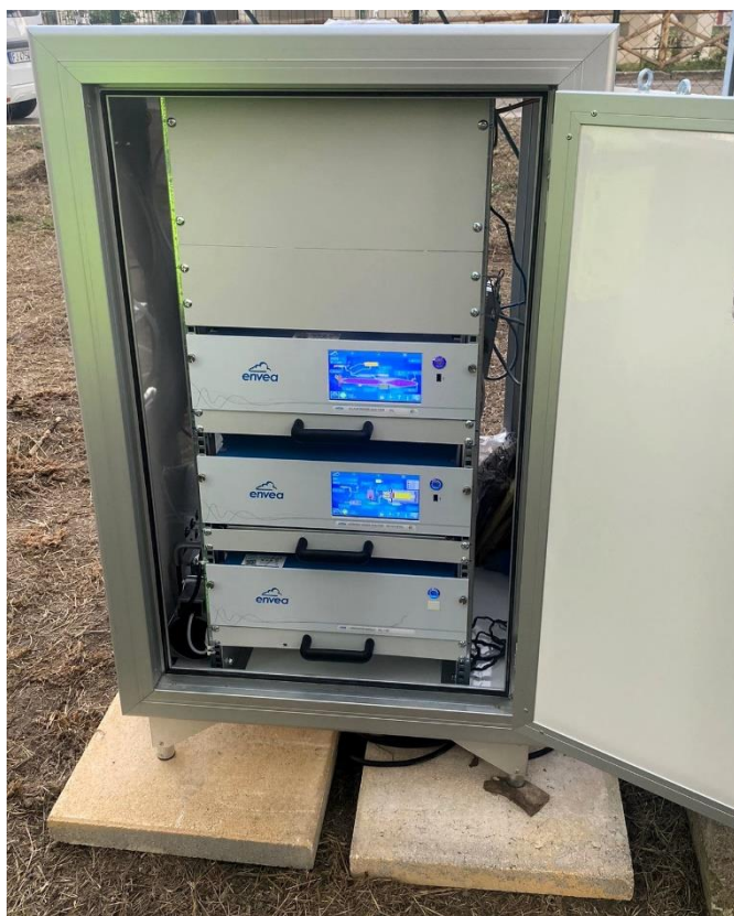
Figura n. 2 Centralina di monitoraggio in continuo H_2S e NH_3
