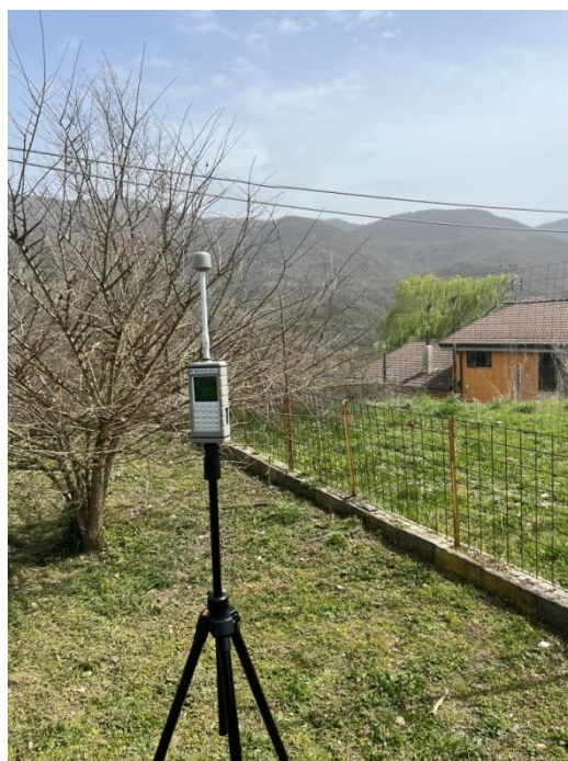
FIGURA 5: PUNTO DI MISURA _ POSIZIONAMENTO STRUMENTO A QUOTA 1.5 M
